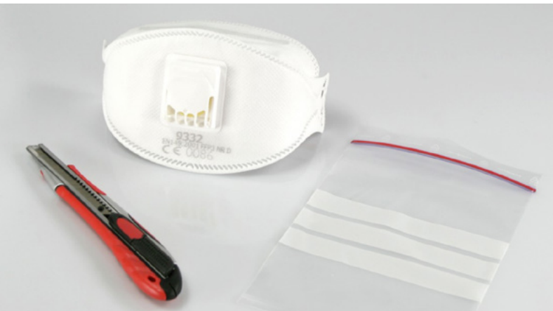
Matériel pour le prélèvement d'échantillons de mastic de fenêtre et de revêtement de sol en matière plastique
